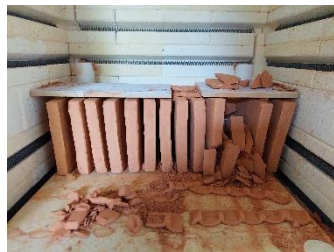
Laden oven. Na ovenstook rood gebakken. Aantal tegels kapot.
