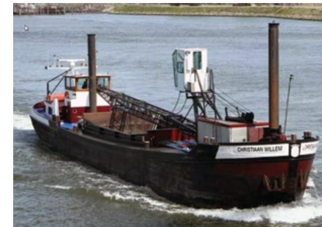
De Christiaan Willem werd in 1983 gekocht en wordt nu door de vierde generatie Schouten gevaren. Het schip is in 1951 gebouwd bij de Rheinwerft te Duisburg. 37,96 x 6,58 x 2,32 meter. Tonnage 281 met een 240 PK GM motor.
