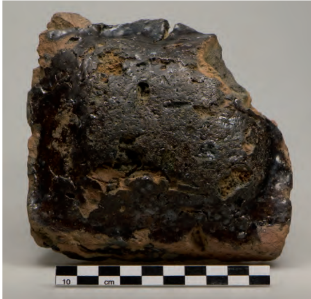
Afb. 6.7. Een tijdens het bakken vervormde geglazuurde plavuis (vnr. 29; stortvondst).
