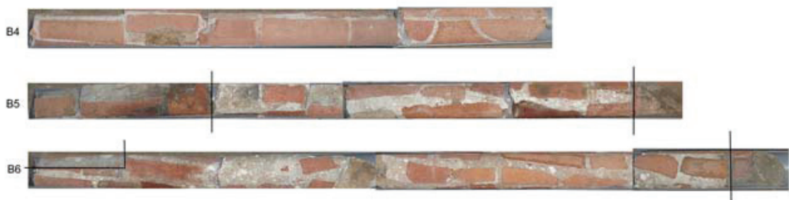
Afb. 10. Boorkernen 4, 5 en 6. De lijnen geven de verschillende fases aan, zoals opgenomen in afbeelding 5, profiel 3. De veldzijde van de muur bevindt zich bij iedere boorkern links.
