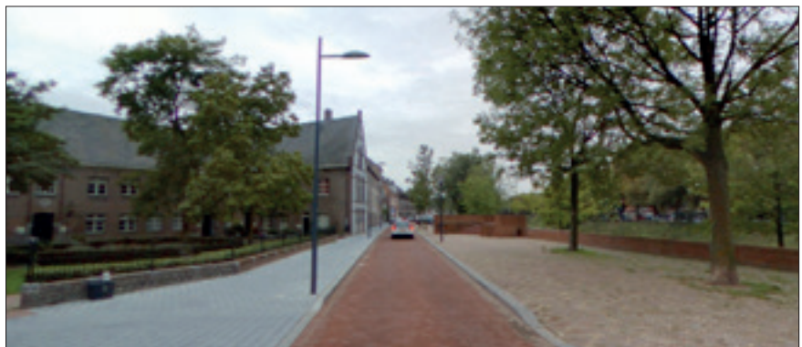
Referentie materiaalgebruik: trottoirs Bossche tegel (beton, anthraciet, 20 x 20 cm), rijbaan gebakken klinkers, lichtmast 6 m. (type Schreder Hestia, kleur RAL...)
