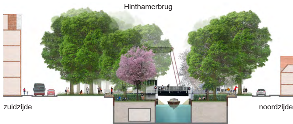
Doorsnede van het idee voor de versmalling van de schutkolk met de mogelijkheid voor een omloopriool en de wens tot het vergroenen van de profielen aan beide zijdes van Sluis 0. In verband met het ontwikkelen van het park en de benodigde groeimogelijkheden / groeiruimte voor 2e en 3e grootte bomen, kan het noodzakelijk zijn om te kiezen voor twee kleinere omloopriolen.
